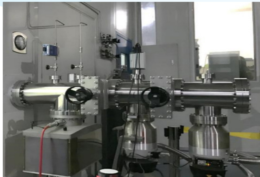
真空镀膜装置
